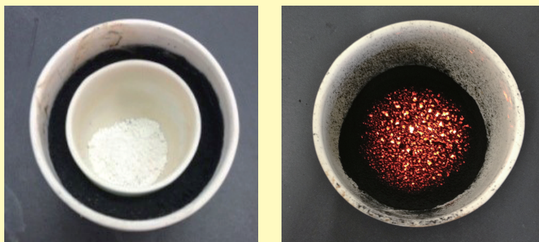
電子レンジを用いた蛍光体の作製方法
