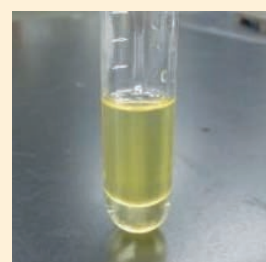
写真7 攪拌後下層の赤褐色が消失する
