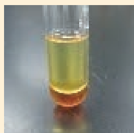
写真6 ポリスチレンの熱分解
