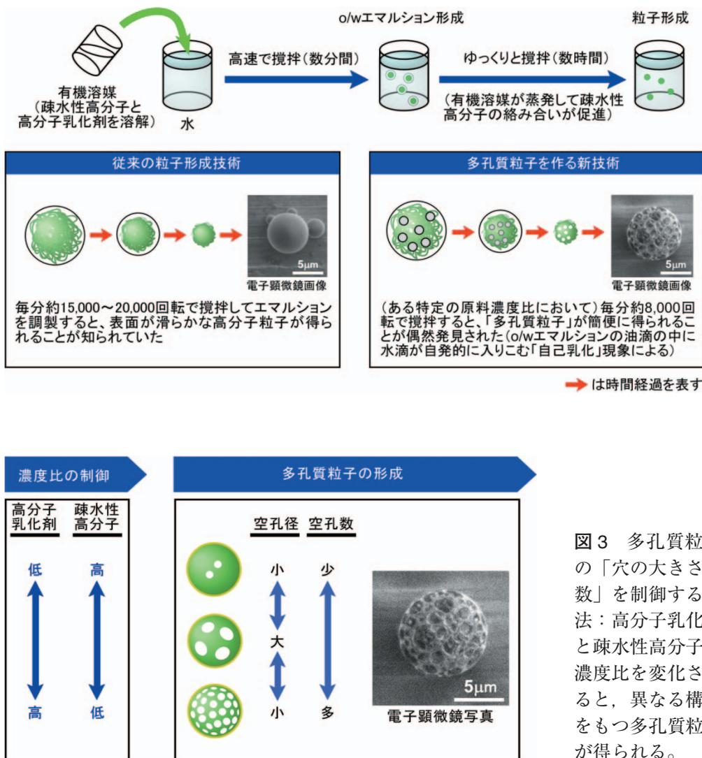
図3 多孔質粒子の「穴の大きさや数」を制御する方法：高分子乳化剤と疎水性高分子の濃度比を変化させると、異なる構造をもつ多孔質粒子が得られる。
