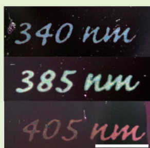
■波長 340, 385, 405 nm の光で架橋したポリスチレン薄膜の構造色：スケールバーは 5 mm（参考図 1）
