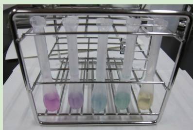
写真1 COD（化学的酸素要求量） 左から 0, 5, 20, 50, 100 mg/L
