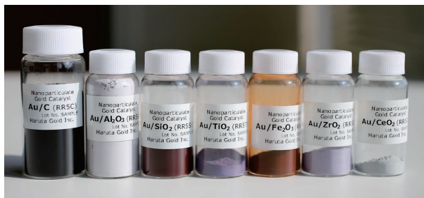
図2 「金」は触媒にならないと信じられていた。しかし、現在では担体ごとに最適な方法を選択することで、ほぼすべての担体に金をナノ粒子として担持することが可能になってきた。金触媒では、固定化する担体の種類により触媒活性だけでなく、選択性も変化する。写真は種々の金属酸化物と炭素材料に担持した金触媒（ハルタゴールド社製）である。P22-23
