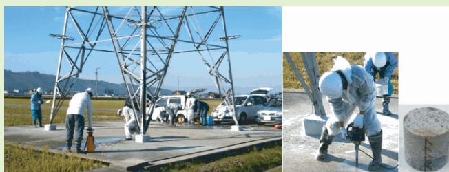
図 3 被雷鉄塔での試料採取。右は 1 インチ径の試料 落雷時の電流は強い円周状磁場を発生する。セメント基礎から塔脚周囲で、エンジン付きドリルで直径 1 インチの円柱試料を複数個採取した。
