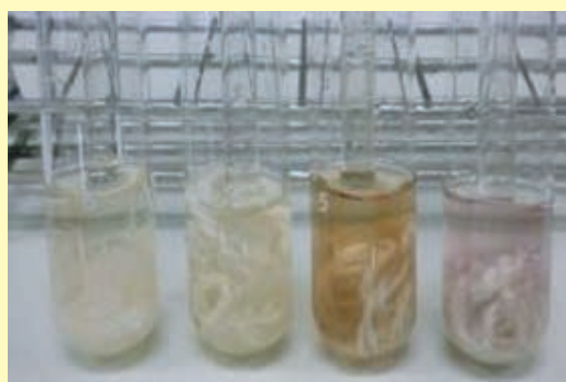
写真3 p -フェニレンジアミンにアンモニア等を加えた水溶液に毛糸を浸した様子 (左から試験管 A, B, C, D)
