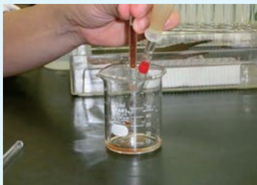
写真2 ピペットを用いて陽イオン交換樹脂を詰めているところ
