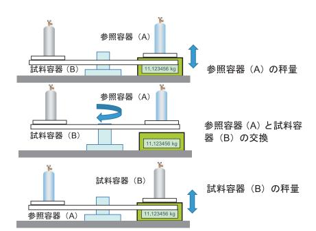
図2 高圧ガス容器の秤量 システム:原料ガスの充っ 質量は、ガス充質量差がスのの高量がスな質量がスな質量がスな質量が表するが、高圧がスないで、高圧がスない。をというでは、標準ガスな質量をで変に、標準がなな質量がないないで、高圧がなな質量を測定している。
