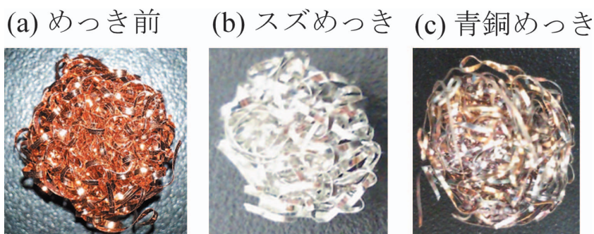
図7 銅製タワシへのスズめっきと青銅めっき
