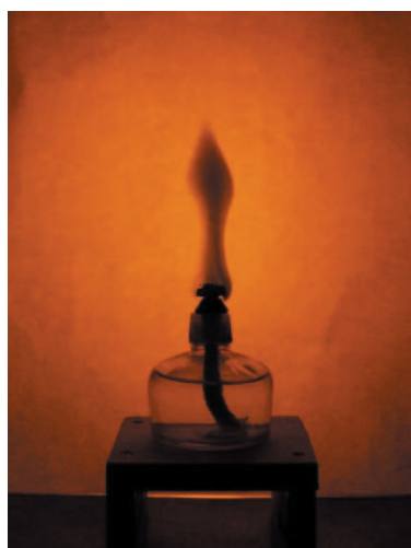
図3 黒い炎 (Naの原子吸光) 写真提供: 大阪市立科学館 長谷川能三のホームページ。 http://www.sci-museum.kita.osaka.jp/~nozo
