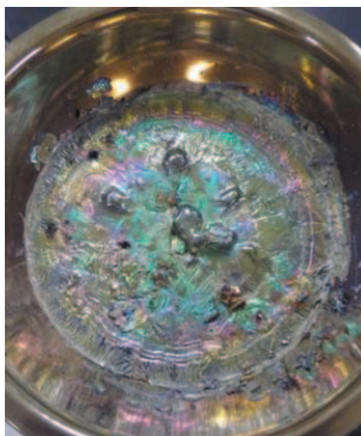
写真4 ビスマスの融点は 271.5^{\circ}\text{C} 、沸点は 1,564^{\circ}\text{C} である。写真はチップが融解し始めた様子。
