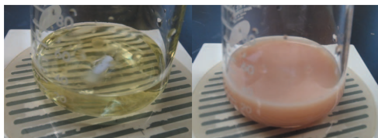
図1 硝酸銀を使った定量実験：モール (Mohr) 法。塩化物イオンの溶液にクロム酸カリウム水溶液を指示薬として加え、硝酸銀で滴定する。滴定開始前は左側 (黄色) で終点は右側 (赤色) に変化する。
