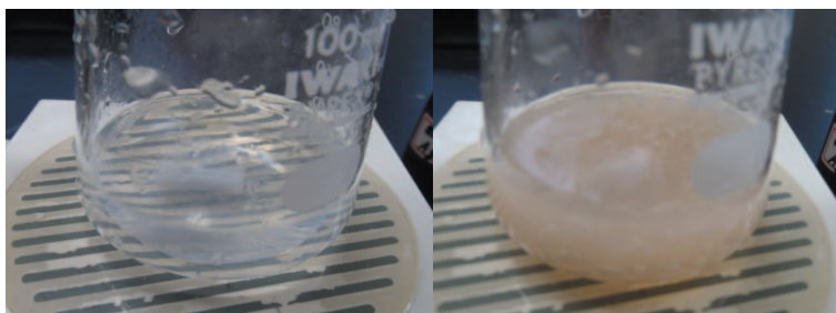
図4 塩化物イオンの溶液に過剰量の硝酸銀を加えて、塩化銀の沈殿を作り、これをろ過する。ろ液中の余剰な銀イオンを、指示薬として鉄ミョウバンを加え、チオシアン酸カリウム水溶液で逆滴定する。難溶なチオシアン酸銀がまず沈殿し、当量点を過ぎたころチオシアン酸鉄(Ⅲ)の橙色の発色がおこるので、これを終点とする。左側の写真は滴定前のろ液 (無色)、右側は終点 (橙色) の様子。
