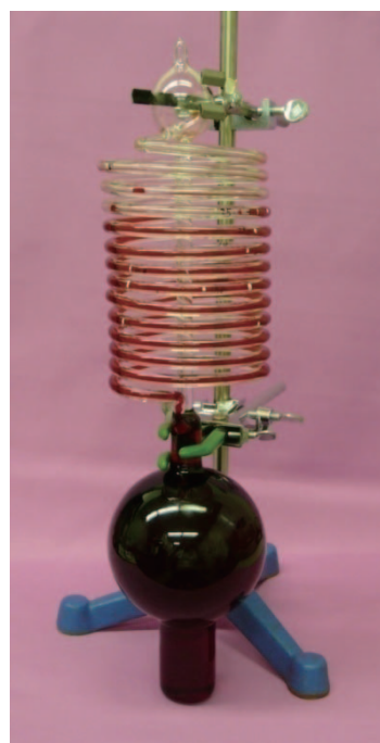
図1 17世紀にイタリア (フィレンツェ) で製作されたアルコール温度計 (産業技術総合研究所 (産総研) 所蔵のレプリカ, 写真提供: 産総研) P372
