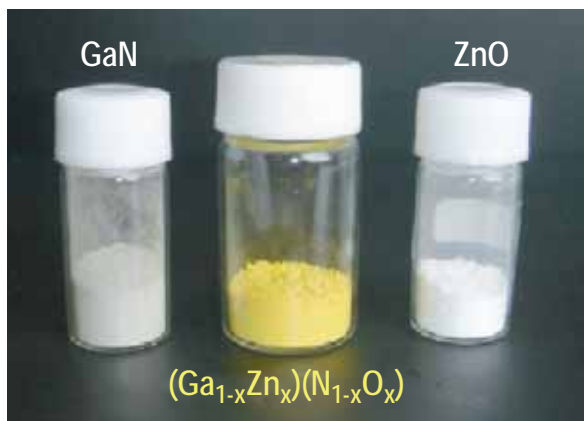
図 2 窒化ガリウム(GaN)、酸化亜鉛(ZnO)、および窒化ガリウム酸化亜鉛固溶体( (\text{Ga}_{1-x}\text{Zn}_x)(\text{N}_{1-x}\text{O}_x) )の写真
