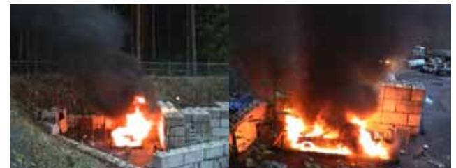
図7 ガソリタンクに火炎が移行した時の状況<color>
