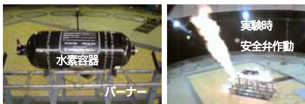
図2 圧縮水素燃料タンクの火炎暴露試験<color>
