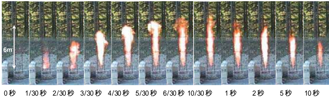
図3 35MPa 水素タンクから水素ガス放出させた場合の水素火炎<color>
