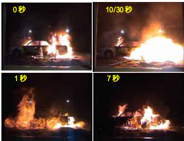
図4 車両に搭載した燃料タンクの安全弁作動時の状況<color>
