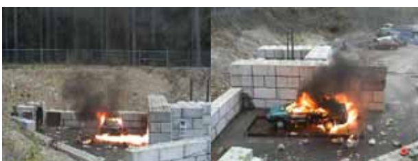
図5 水素容器搭載車の安全弁作動時の状況<color>
