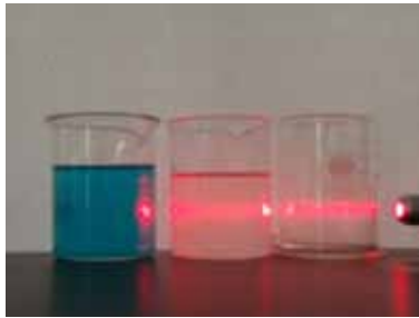
図1 左から、硫酸銅(Ⅱ)水溶液，セッケン水，線香の煙
